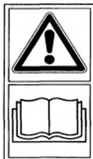
Рисунок 8 – Пример пиктограммы, обозначающей: «Читай руководство по эксплуатации»
