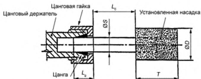
$D$  – диаметр сменного инструмента;  $S$  – диаметр хвостовика сменного инструмента;  $L_0$  – длина зажима;  $T$  – длина сменного инструмента;  $L_0$  – выступ
