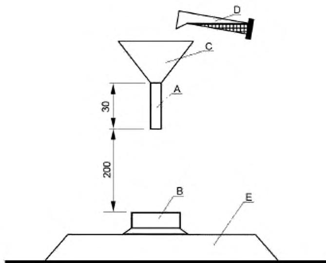
А - выливающая трубка внутренним диаметром 8 мм; В - испытуемый образец;
