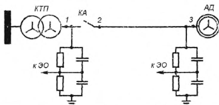
1, 2, 3 – возможные точки подключения устройств защиты; КТП – комплектная трансформаторная подстанция; КА – коммутационный аппарат; АД – асинхронный двигатель; к ЭО – к электронному осциллографу
