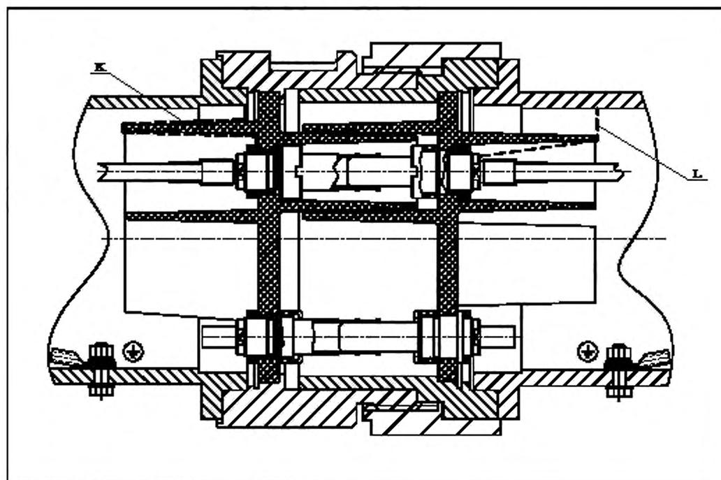
K—пути утечки; L—электрические зазоры
