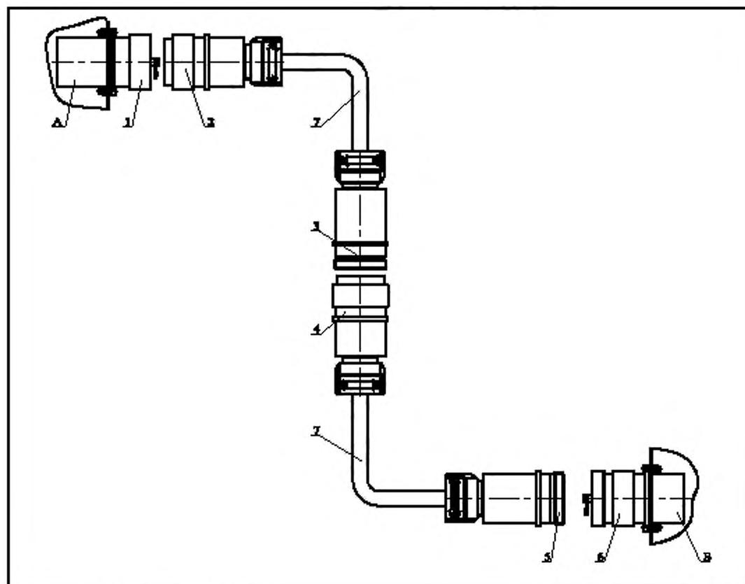
А- пункт питания (трансформаторная подстанция, комплектный распределительный пункт, приключательный пункт и др.); 1 – разъем приборный исполнения РПВЛ: РП – розетка приборная (встраиваемая), ВЛ – вилка линейная; 2 – гибкий кабель; 3 – разъем линейный исполнения РЛВЛ: РЛ – розетка линейная, ВЛ – вилка линейная; 4 – разъем приборный исполнения РЛВП: РЛ – розетка линейная, ВП – вилка приборная (встраиваемая); Б – потребитель энергии (экскаватор, буровой станок, конвейер и пр.)
