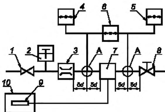
1 — регулятор давления; 2 — термометр; 3 — расходомер; 4, 5 — манометры; 6 — дифференциальный манометр,
