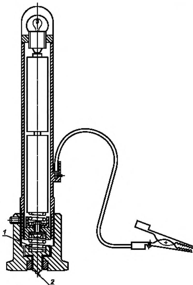
1 — пружина; 2 — рабочая точка (стальной шарик диаметром 1 мм)
