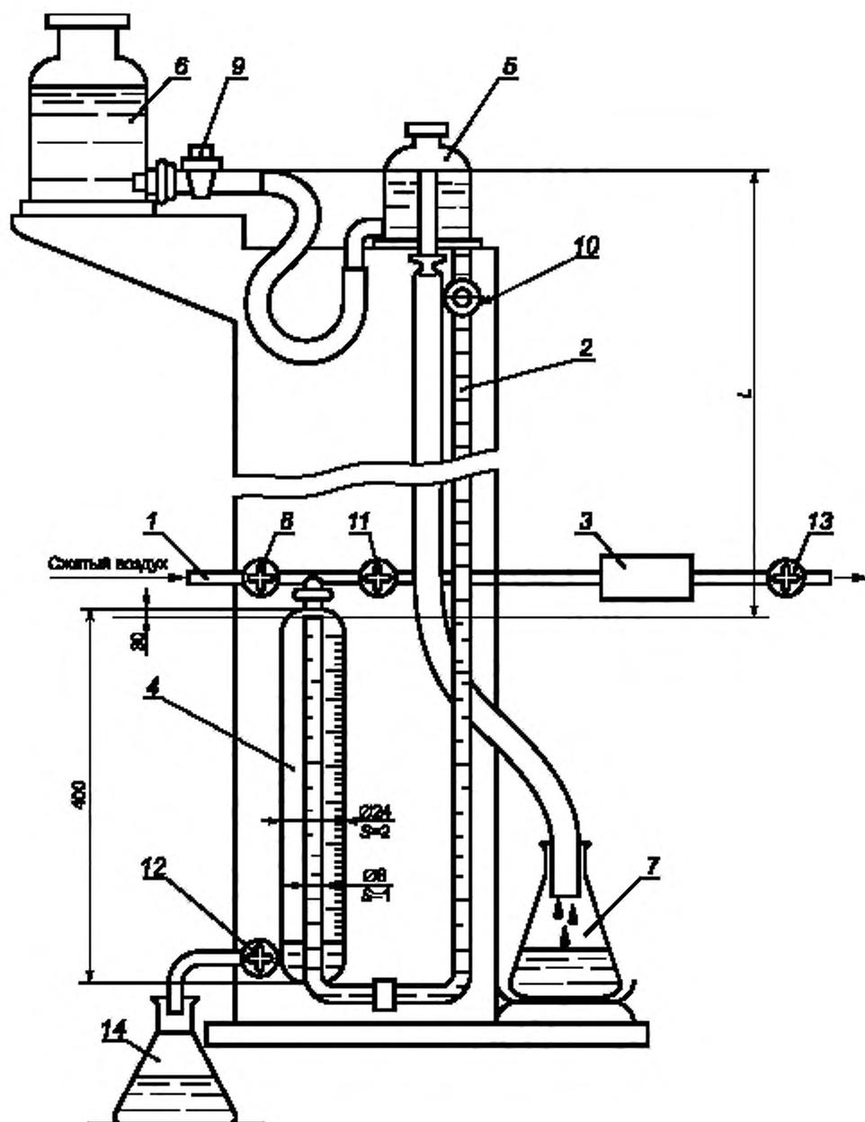
1 — сжатый воздух; 2 — градуированная шкала; 3 — испытуемый образец; 4 — измерительная бюретка;
