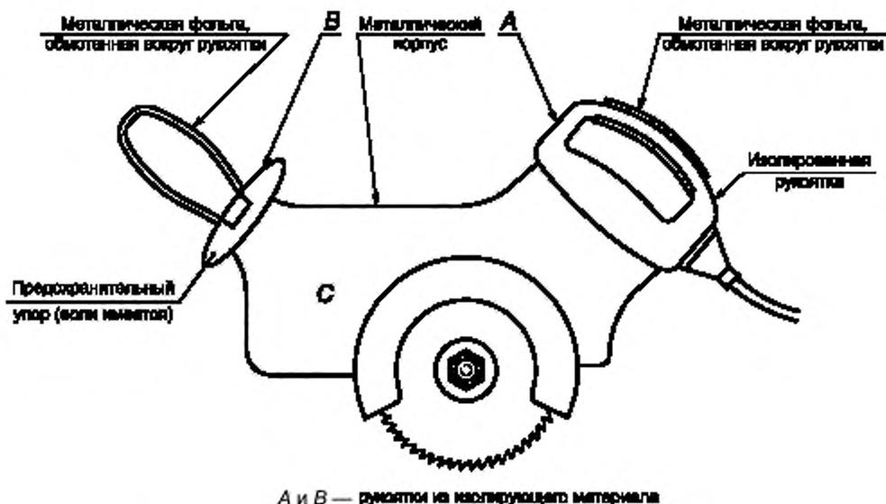
Рисунок 14 — Переносная электрическая пила с эквивалентом руки (см. 7.4.2.3)
