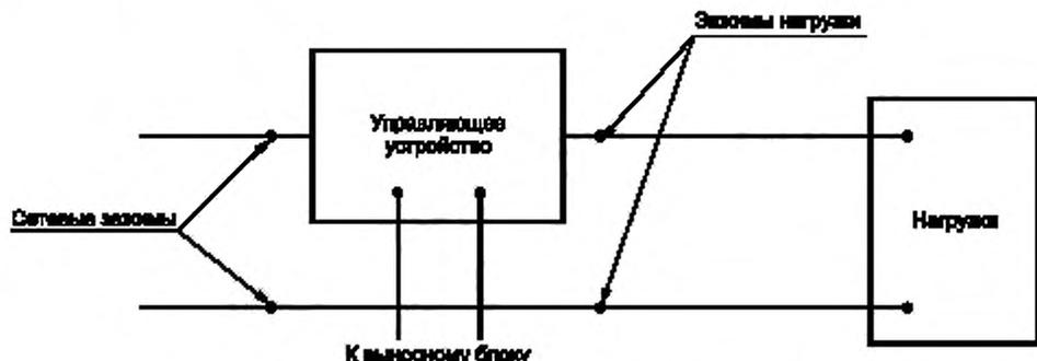
Рисунок 16а — Схема измерения для двухзажимных управляющих устройств
