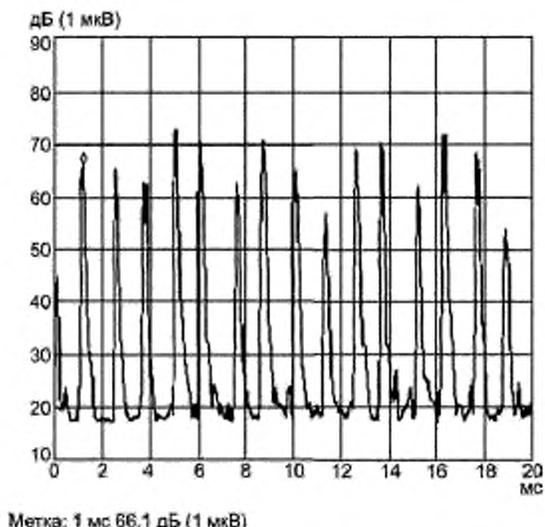
ИРП от коллекторного двигателя, работающего от источника постоянного тока. Из-за большого количества коллекторных сегментов частота повторения импульсов высокая (приблизительно 800 Гц) и амплитуда импульсов существенно изменяется. Следовательно, в этом примере рекомендуемое время измерения > 10 мс при пиковом детектировании
