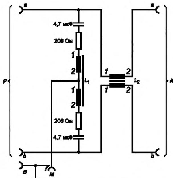
1 — начало обмотки; 2 — конец обмотки; А — зажимы для подключения линии связи; В — зажим опорного заземления; М — вход измерительного приемника (50 Ом); Р — подключение к испытываемому ТС;  $L_1$  — индуктивность симметричного режима (от 5 до 40 мГн для каждой обмотки);  $L_2$  — индуктивность развязки
