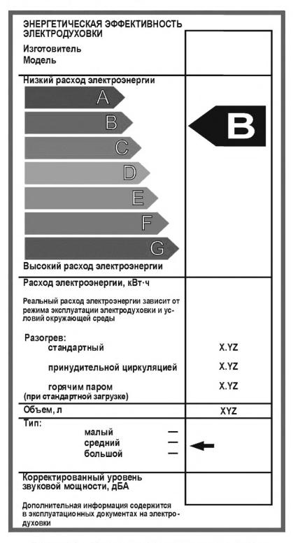
Рисунок А.1 — Маркировка эффективности электрошкафа
