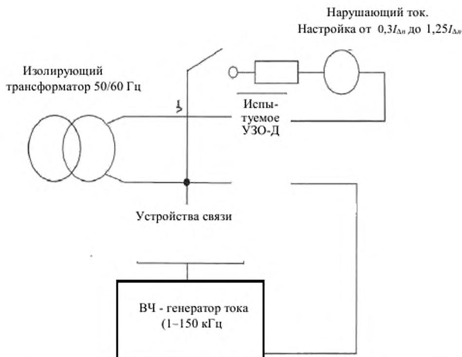
**Примечание** – Требования к ВЧ-генератору тока – по ГОСТ Р 51317.4.16. Если УЗО-Д имеет зажим заземления, он должен быть соединен с зажимом нейтрального проводника (если таковые имеются и отмечены на УЗО-Д) или соединен проводником с любым зажимом фазы.
