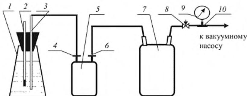
1 — коническая колба; 2 — термометр; 3 — трубка; 4 и 6 — клапаны; 5 — калориметрическая бомба; 7 — склянка Вульфа; 8 — кран; 9 — вакуумметр; 10 — соединительная T-образная трубка
