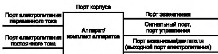
Рисунок 3 — Примеры портов аппарата/комплекта аппаратов
