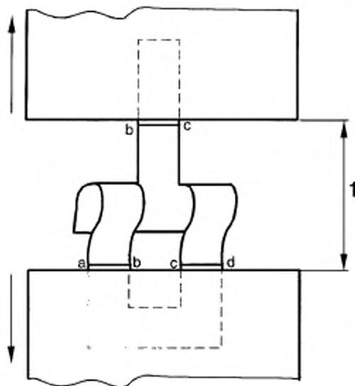
1 – длина измерительного прибора (уменьшенная при закреплении)
