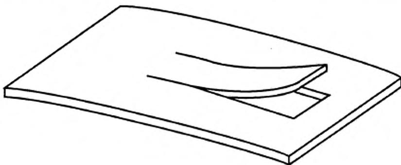
Рисунок 1— Пример испытуемого образца в форме языка
