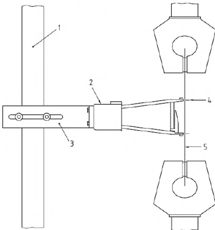
1 – рама машины для испытаний на растяжение; 2 – экстензометр; 3 – установочный кронштейн;
