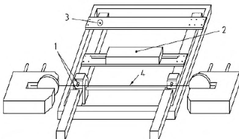
1 – ножевая опора экстензометра; 2 – оптический прибор измерения перемещения;
