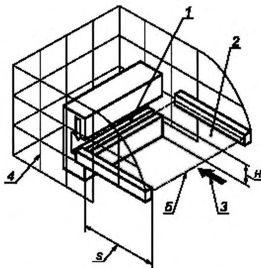
$H$  — высота зоны обнаружения над базовой плоскостью;  $S$  — минимальное расстояние; 1 — опасная зона; 2 — зона обнаружения; 3 — направление приближения; 4 — неподвижное защитное ограждение; 5 — начало зоны обнаружения
