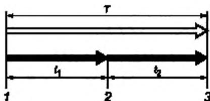
1 — приведение в действие предохранительного оборудования; 2 — управление (срабатывание) предохранительного оборудования; 3 — исключение риска
