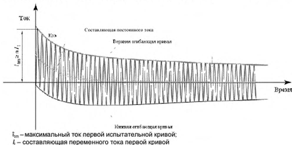
Рисунок 9 – Форма тока короткого замыкания во время испытания
