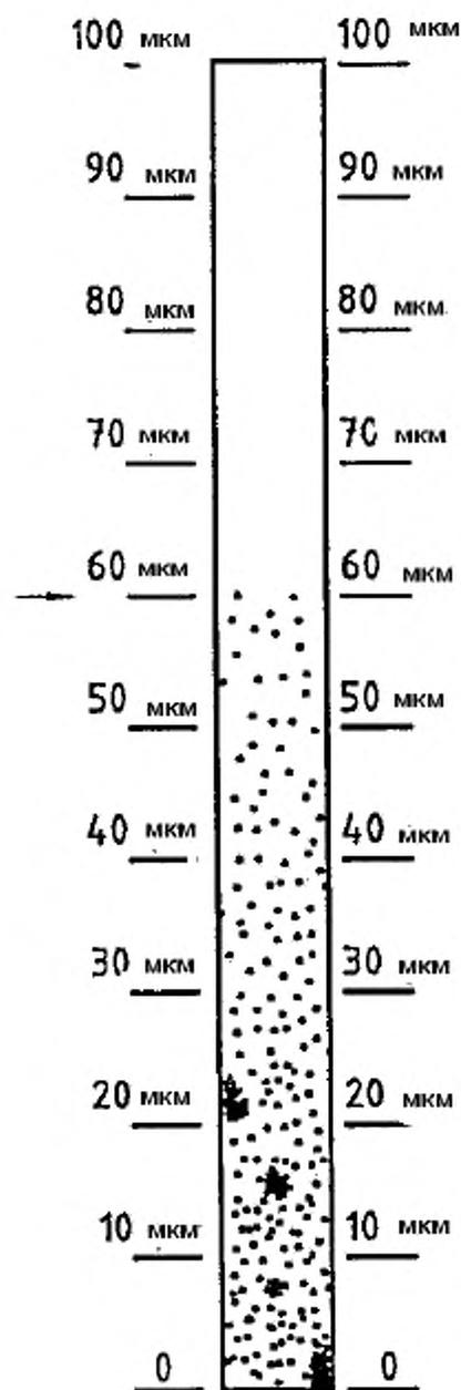
Рисунок 3 – Вид прибора с испытанным образцом
