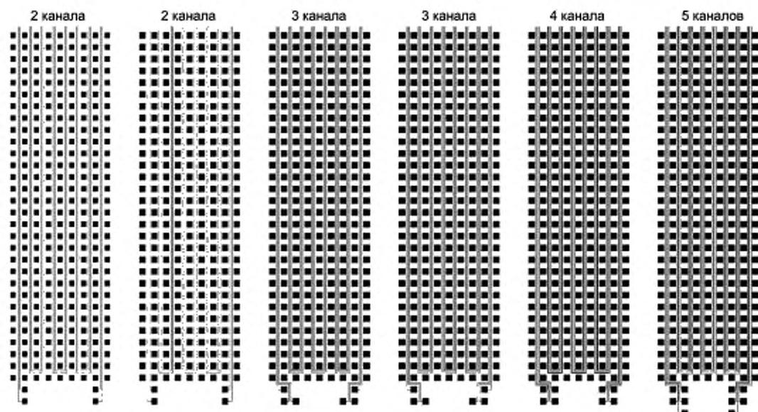
Рисунок 13 — Тестовая модель способности трассировки проводников
