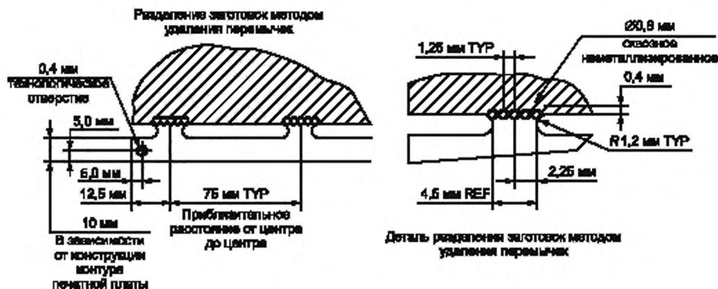
Рисунок 20 — Удаление перемычек (модель фрезерования) с фрезерованными щелями
