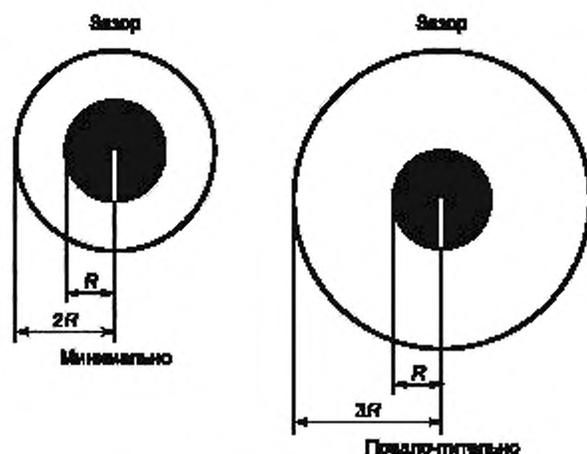
Рисунок 11 — Требования к зазору вокруг реперного знака
