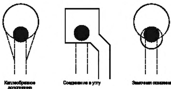
Рисунок 17 — Примеры измененных соединений проводника и контактной площадки
