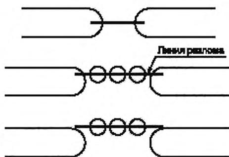
Рисунок 21 — Фрезерованные щели
