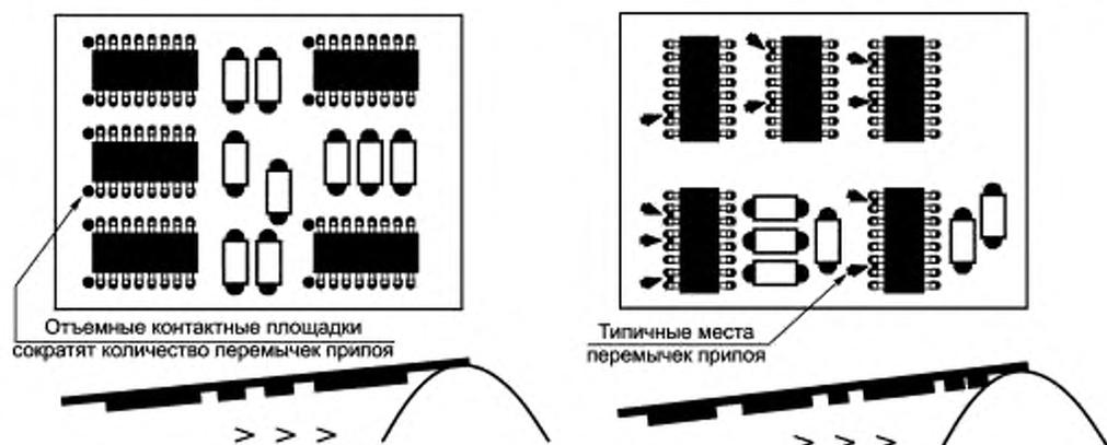
Рисунок 6 — Ориентация компонента для применения пайки волной
