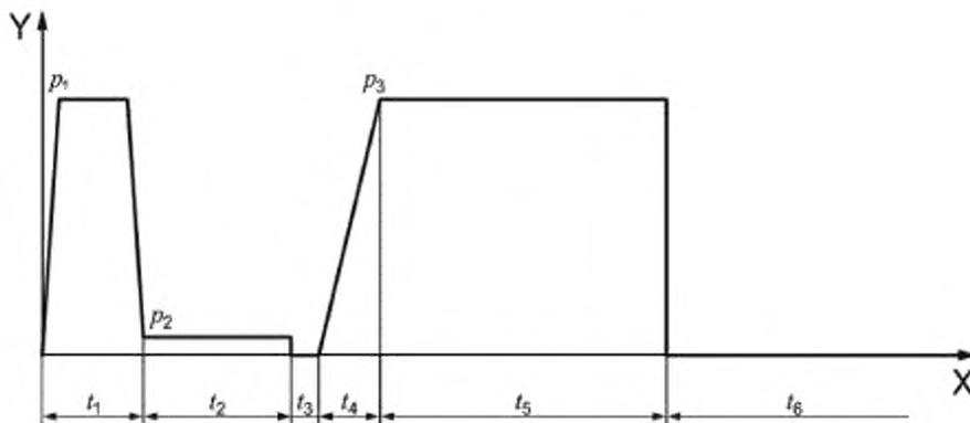
X — время; Y — давление;  $t_1$  — время выравнивания;  $t_2$  — время прогрева;  $t_3$  — время технологической паузы;  $t_4$  — время подъема давления;  $t_5$  — время охлаждения в машине под давлением;  $t_6$  — время охлаждения в машине без давления или вне машины;  $p_1$  — давление выравнивания;  $p_2$  — давление при прогреве;  $p_3$  — давление при сварке
