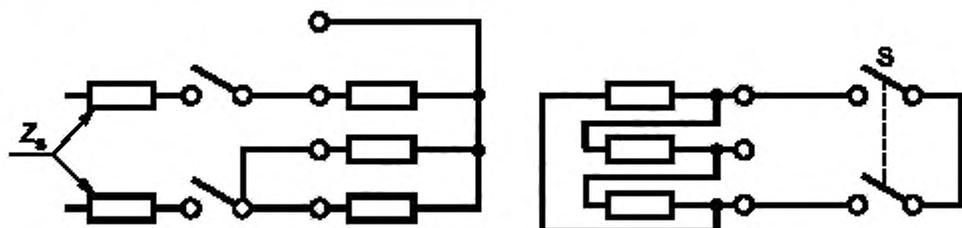
$Z_0$  — сопротивление испытательной схемы; S — синхронный выключатель для последующего КЗ или жесткое соединение для предварительного КЗ
