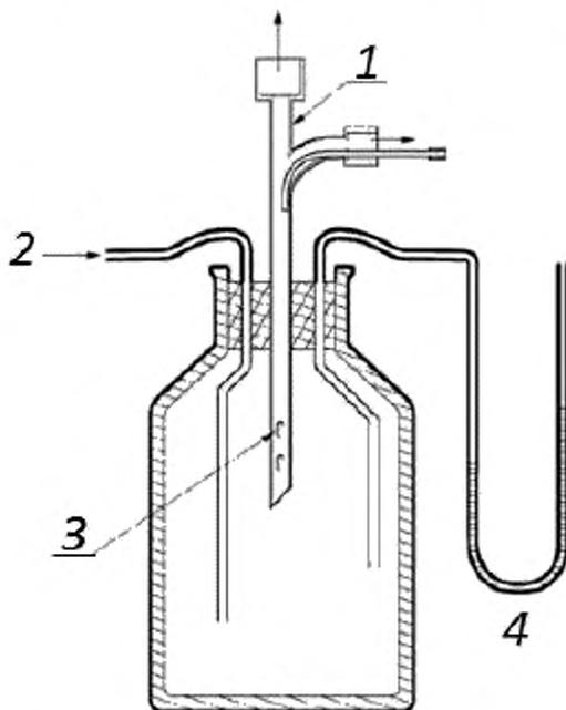
1 – жесткий бронхоскоп; 2 – поступление воздуха от средства измерений потока; 3 – боковые отверстия должны быть внутри резервуара; 4 – средство измерений давления, например, водяной манометр
