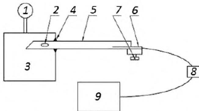
1 – контрольный манометр; 2 – боковые отверстия, которые должны быть внутри испытательной емкости; 3 – испытательный резервуар («легкие») емкостью 4 л; 4 – герметичное уплотнение; 5 – испытуемый бронхоскоп; 6 – струйный инжектор; 7 – зажим; 8 – выключатель; 9 – регулируемый редуктор давления
