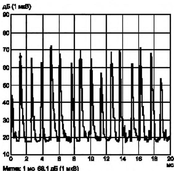
**Примечание** — ИРП от коллекторного двигателя, работающего от источника постоянного тока. Из-за большого числа коллекторных сегментов частота повторения импульсов высокая (приблизительно 800 Гц) и амплитуда импульсов существенно изменяется. Следовательно, в этом примере рекомендуемое время измерения > 10 мс при пиковом детектировании.
