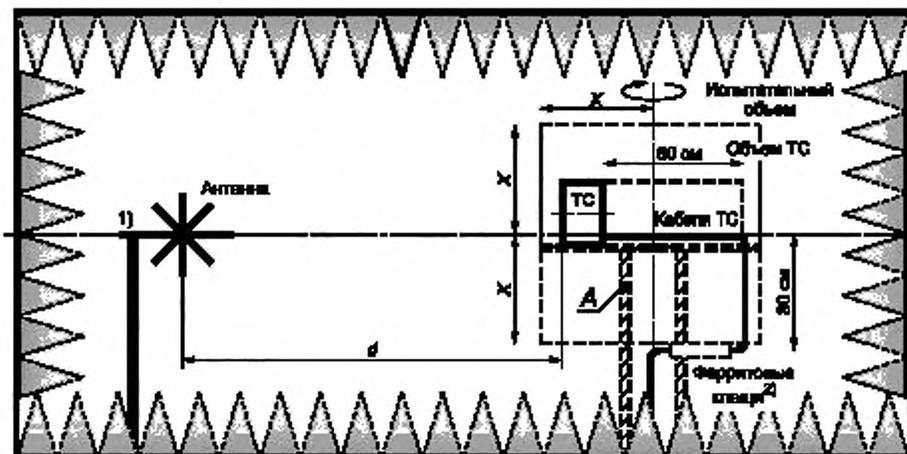
A — поворотная платформа и опора для испытуемого ТС;  $d$  — измерительное расстояние, равное 3; 5 или 10 м;  $2X = 1,5; 2,5; 5$  м (при измерительных расстояниях 3; 5 или 10 м соответственно)
