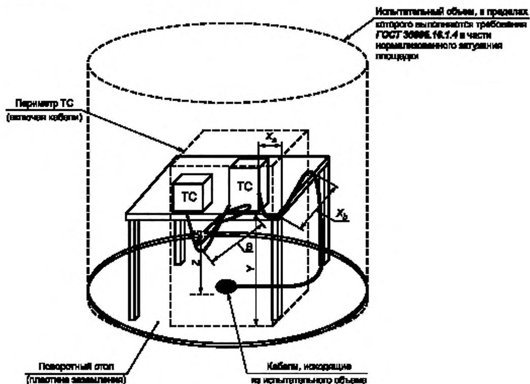
$X_a$  — длина горизонтального участка кабеля, перпендикулярного ТС, равная  $(0,2 \pm 0,02)$  м;  $X_b$  — длина горизонтального участка кабеля, параллельного ТС, равная  $(0,8 \pm 0,08)$  м;  $Y$  — длина вертикального участка кабеля, идущего от края стола к пластине заземления;  $Z$  — минимальное расстояние от соединительных кабелей, свисающих со стола, до пластины заземления, равное  $(0,4 \pm 0,04)$  м;  $B$  — длина плоской петли, равная 30—40 см (излишняя длина кабеля)
