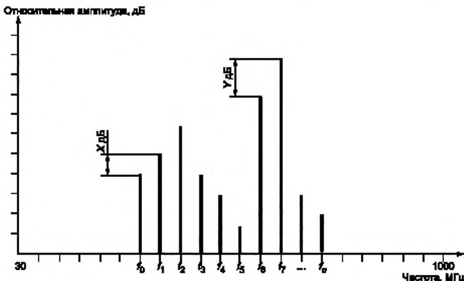
**Примечание** — В общем случае значение  $f_n$  равно  $n f_0$ , где  $f_0$  — основная частота излучения испытуемого ТС (основная тактовая частота).
