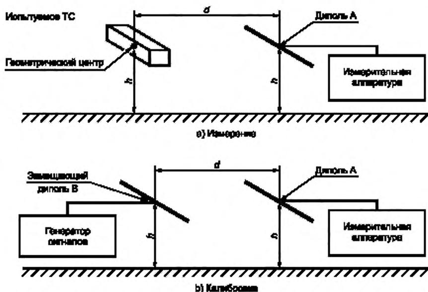
Рисунок 16 — Измерение методом замещения (см. 7.4.1 и 7.4.3)
