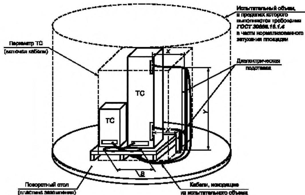
$X$  — длина горизонтального участка кабеля, параллельного одной из сторон периметра ТС и перпендикулярного его соседней стороне, равная  $(0,3 \pm 0,03)$  м;  $Y$  — длина вертикального участка кабеля;  $B$  — длина плоской петли, равная 1 м (излишняя длина кабеля)
