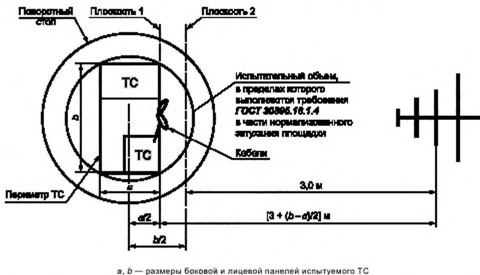
$a$ ,  $b$  — размеры боковой и лицевой панелей испытуемого ТС
