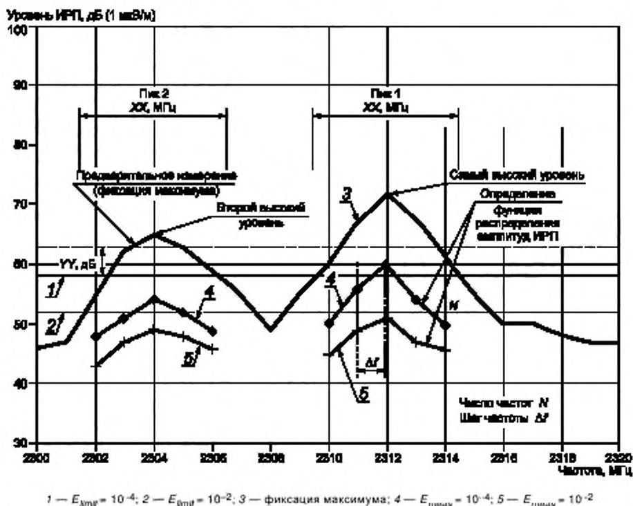
Рисунок Е.1 — Пример применения функции распределения амплитуд для флюктуирующих помех, метод 1
