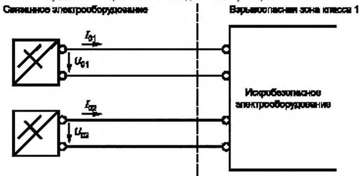
Новые максимальные параметры системы:  $U_0 = \Sigma U_{0i} = U_{01} + U_{02}$ ;  $I_0 = \max ( I_{0i} )$  или  $U_0 = \max ( U_{0i} )$ ;  $I_0 = \Sigma I_{0i} = I_{01} + I_{02}$
