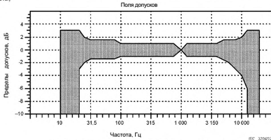
Рисунок В.1 – Допуска для частотной характеристики, по [7], тип 1
