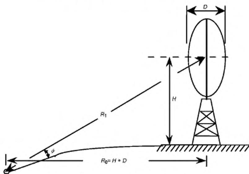
Рисунок 4б – ВЭУ с вертикальной осью вращения
