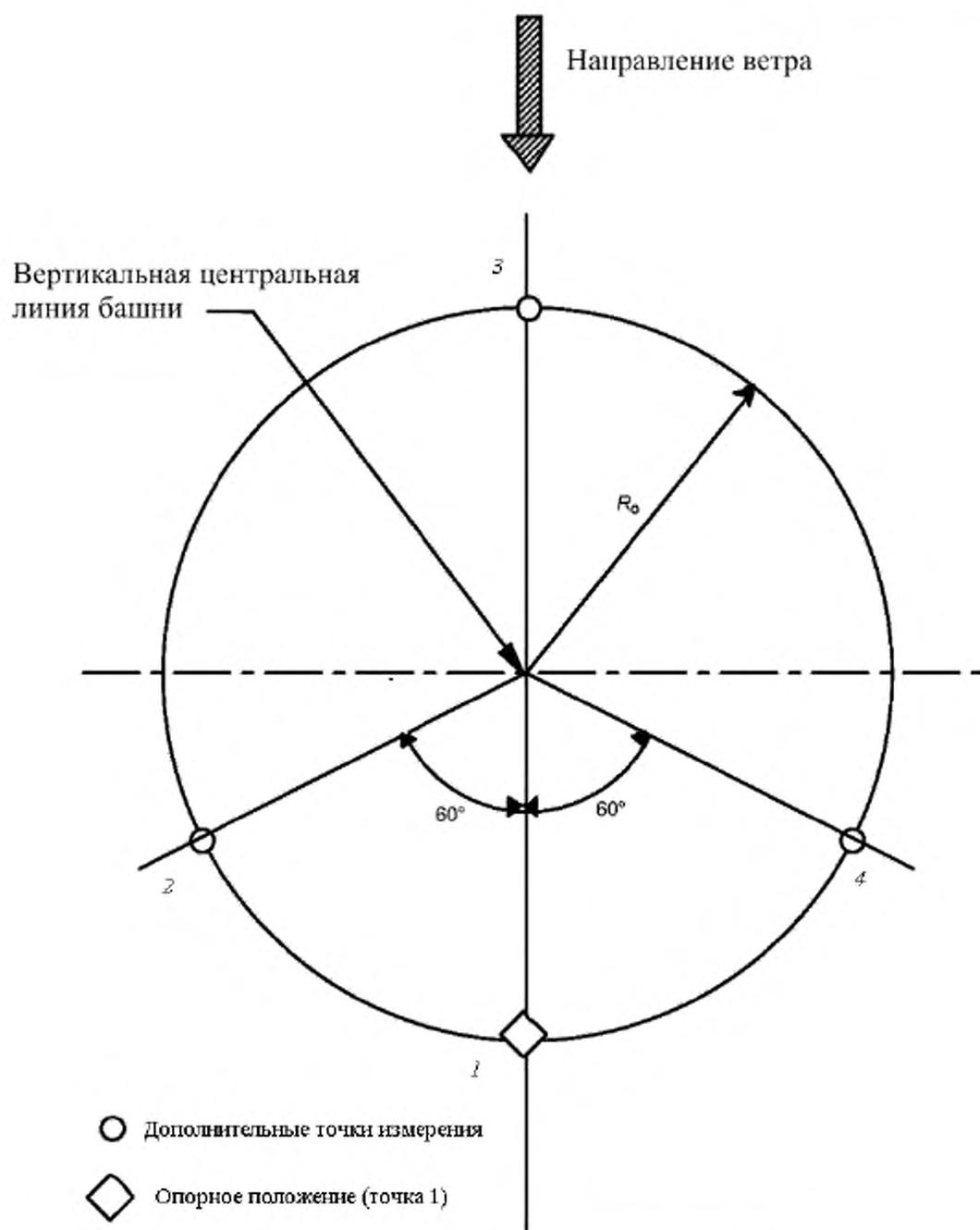
Рисунок 3 – Стандартная схема мест расположения микрофонов (вид сверху)
