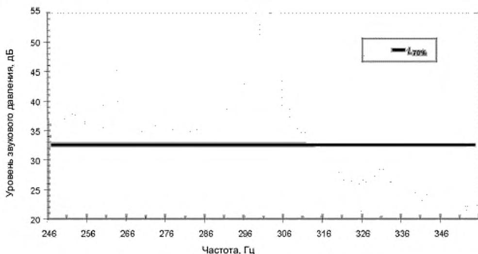
Рисунок 8 – Иллюстрация уровня  $L_{70\%}$  в критичной полосе частот
