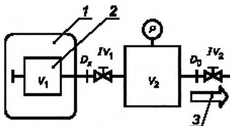
1 — система, заполненная гелием; 2 — испытываемая система; 3 — выход
