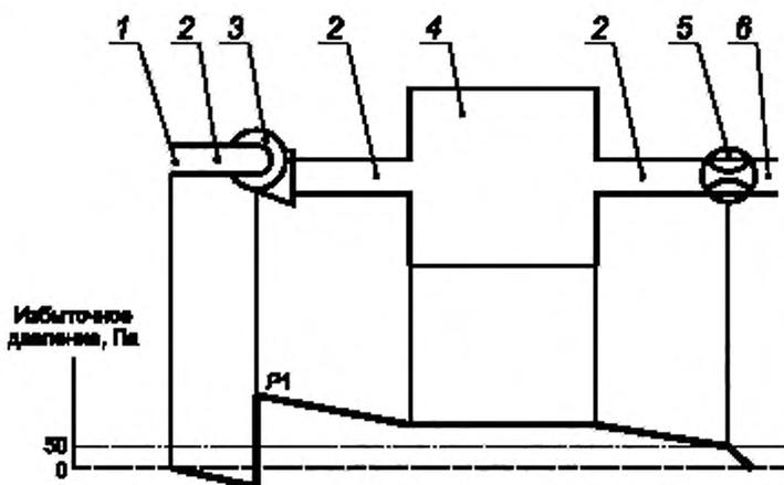
1 — вход защитного газа; 2 — газопровод; 3 — вентилятор; 4 — оболочка; 5 — дроссельная заслонка;
