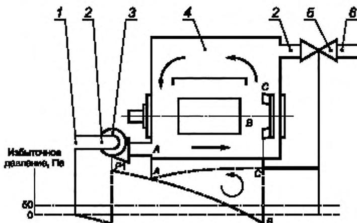
1 — вход защитного газа; 2 — газопровод; 3 — вентилятор; 4 — оболочка; 5 — выходной клапан;
