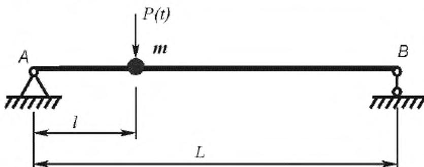
А – шарнирно-неподвижная опора трубопровода; В – шарнирно-подвижная опора трубопровода.  $l$  – расстояние расположения массы  $m$  от левой опоры трубопровода А.  $P(t) = P_0 \sin(2\pi ft)$  – вертикальная сила, действующая на массу  $m$
