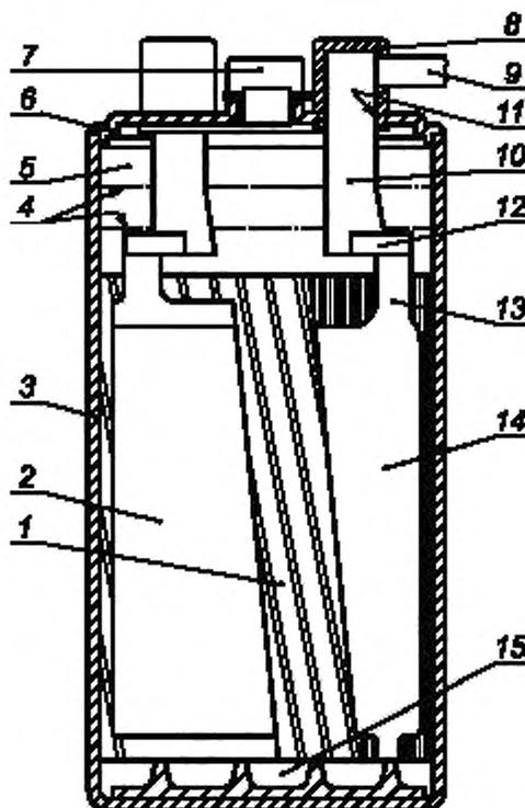
1 - сепаратор; 2 - положительно заряженная пластина, 3 - контейнер элемента, 4 - уровень электролита (макс./мин.);
