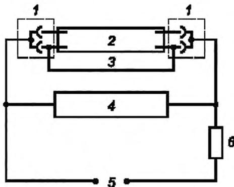
1 – ламповый патрон; 2 – лампа; 3 – соединение; 4 – осциллограф;
