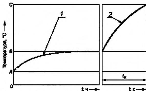
A – наивысшая допустимая окружающая температура; B – температура в номинальном режиме работы; C – предельная температура;  $t$  – время: 1 – повышение температуры в номинальном режиме работы; 2 – повышение температуры статора и ротора при испытании электродвигателя с заторможенным ротором
