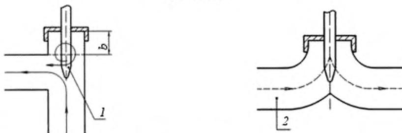
*a* – мертвая зона, где задерживается воздух и образуется конденсат; *b* – короткозамкнутый отрезок; 1 – датчик; 2 – изогнутый гройник
