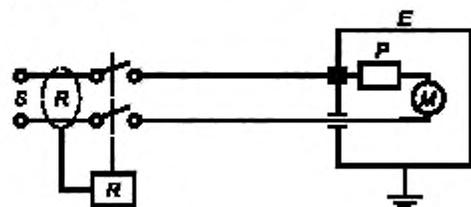
S — сеть питания; E — кожух электродвигателя; R — устройство защитного отключения ( $I_{дл} = 30\text{ мА}$ ) (выключатель или выключатель с защитой от перегрузки); P — защитное устройство (внешнее или внутреннее); M — электродвигатель
