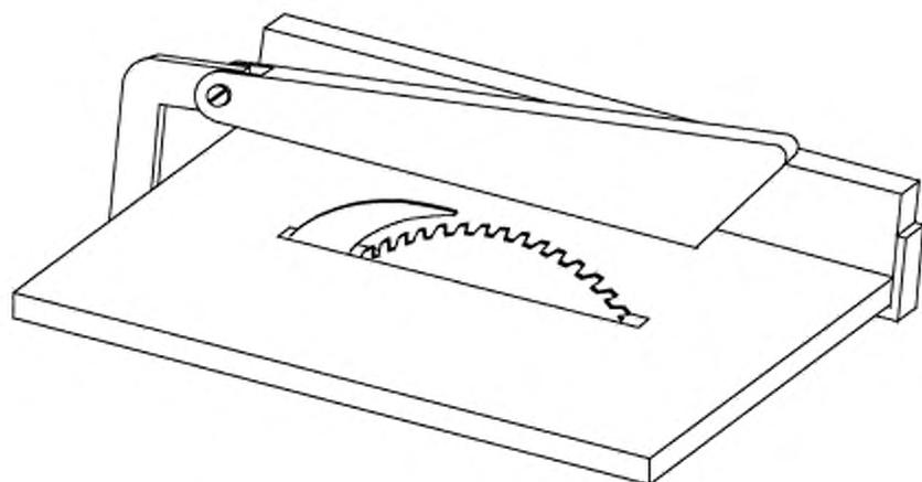
Рисунок 110 — Ограждение пильного диска в режиме дисковой пилы
