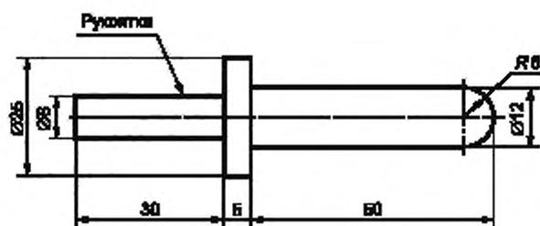
Рисунок 103 — Испытательный щуп
