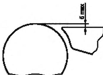
Рисунок 106 — Положение раскливающего ножа
