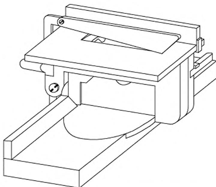
Рисунок 108 — Комбинированная пила в режиме дисковой пилы
