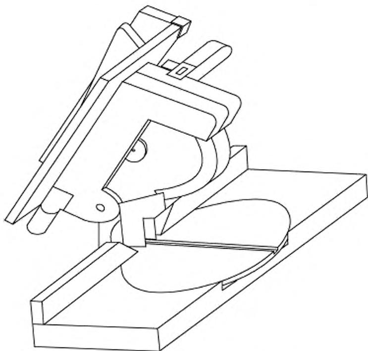
Рисунок 109 — Комбинированная пила в режиме торцовочной пилы
