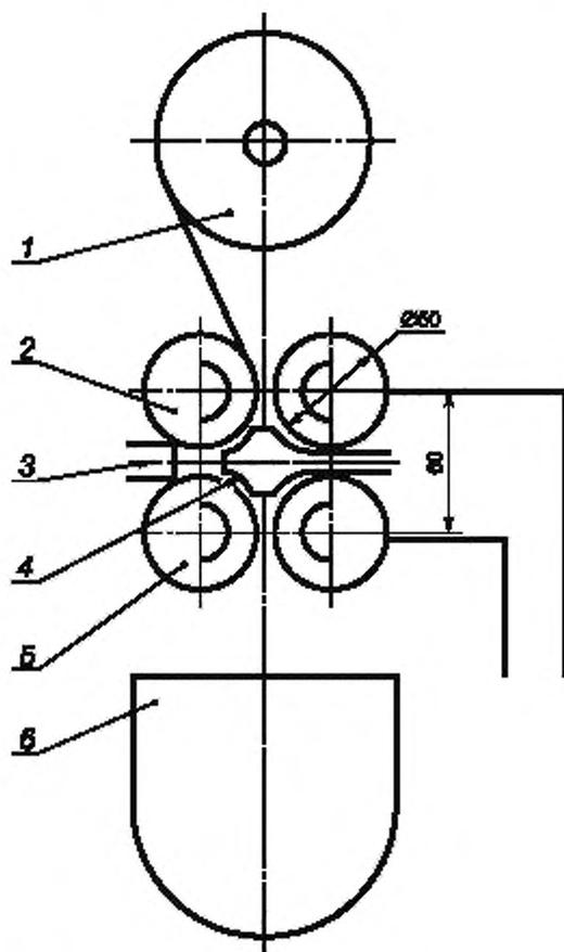
1 — барабан с проволокой; 2 — подающие ролики; 3 — датчик взрыва; 4 — взрывная камера; 5 — принимающие ролики;
