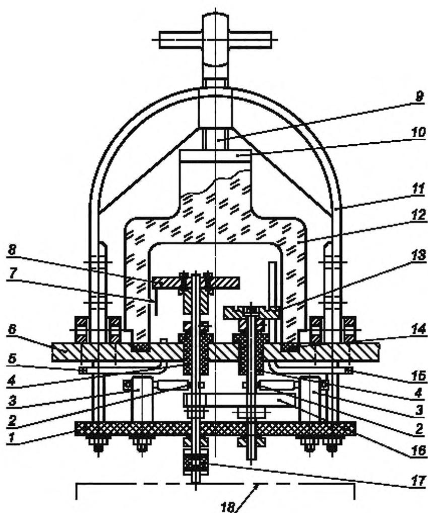
1 — изолирующая пластина; 2 — подвод тока; 3 — изолированный болт; 4 — изолированный подшипник; 5 — выходное отверстие для газа; 6 — цоколь основания; 7 — вольфрамовая проволочка; 8 — держатель проволочек; 9 — зажимной винт; 10 — нажимная пластина; 11 — зажим; 12 — камера; 13 — кадмиевый контактный диск; 14 — резиновое уплотнение; 15 — входное отверстие для газа; 16 — шестерня 50:12; 17 — изолированная муфта; 18 — приводной двигатель с редуктором
