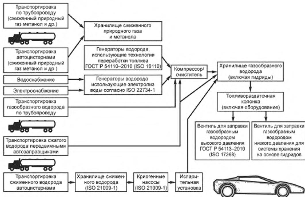
Рисунок 1 — Газообразный водород — заправочная станция
