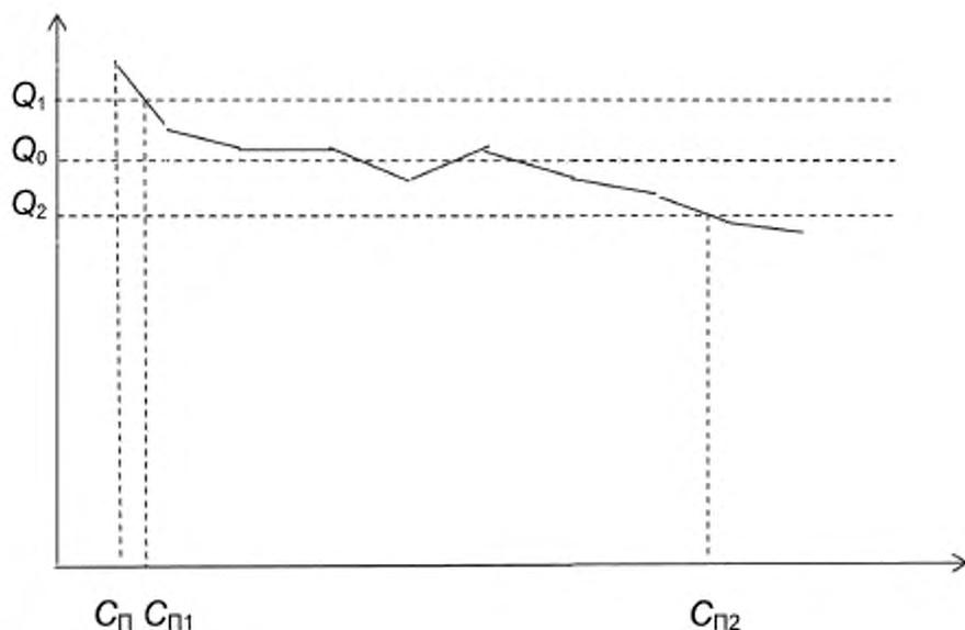
$Q_0$  — уровень линейного диапазона;  $Q_1 = 1,05Q_0$ ;  $Q_2 = 0,95Q_0$ ;  $C_p$  — концентрация, соответствующая пределу детектирования;  $C_{п1}$  — концентрация, соответствующая нижнему пределу линейного диапазона;  $C_{п2}$  — концентрация, соответствующая верхнему пределу линейного диапазона
