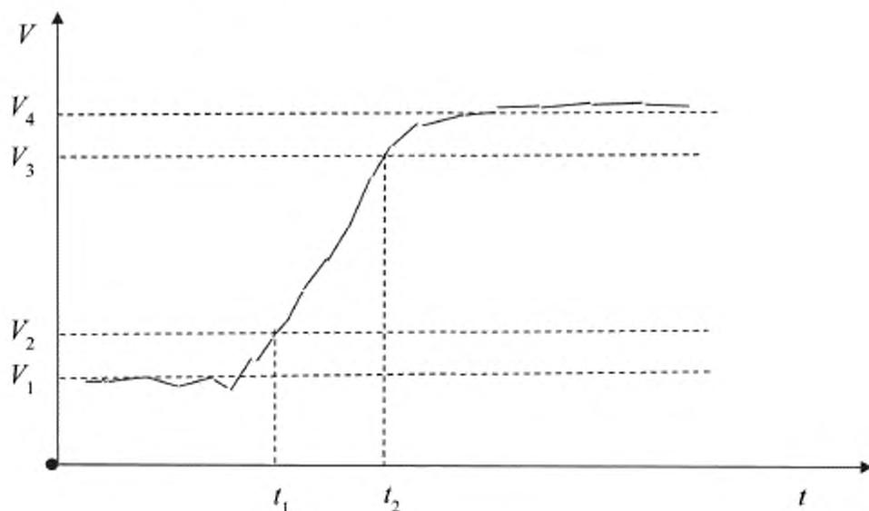
$V$  — выходной сигнал детектора;  $t$  — время;  $V_1$  — первоначальное установившееся значение выходного сигнала;
