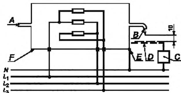
*A* — входное отверстие для воды; *B* — выходное отверстие для воды; *C* — схема на рисунке 4 IEC 60990,
