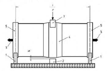
1 – опора под торцевой заглушкой; 2 – ограничитель; 3 – продольная нагрузка; 4 – испытуёмое соединение; 5 – торцевая заглушка; 6 – предельное отклонение; 7 – хомут; F – поперечная нагрузка; L – длина образца
