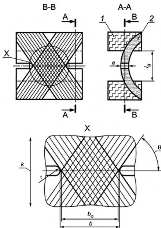
1 — термореактивная смола; 2 — образец из отрезка трубы;  $b_g$  — ширина образца в области разрыва;  $k$  — направление вдоль окружности,  $b$  — ширина испытываемого участка
