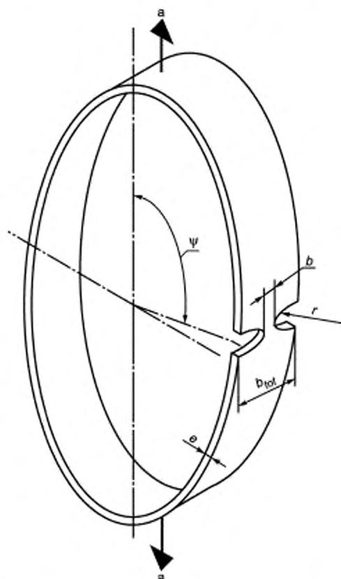
$e$  — толщина стенки образца;  $b_{tot}$  — общая ширина образца;  $b$  — ширина испытываемого участка образца;  $r$  — радиус надреза;  $\psi$  — угол, определяющий расположение надреза относительно направления растягивающей силы
