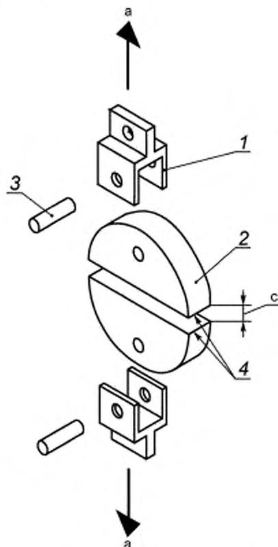
1 — вилчатый захват; 2 — поверхность полудиска, на которую устанавливают образец; 3 — фиксирующий штифт; 4 — закругленные кромки полудисков; а — направление приложения нагрузки; с — расхождение полудисков
