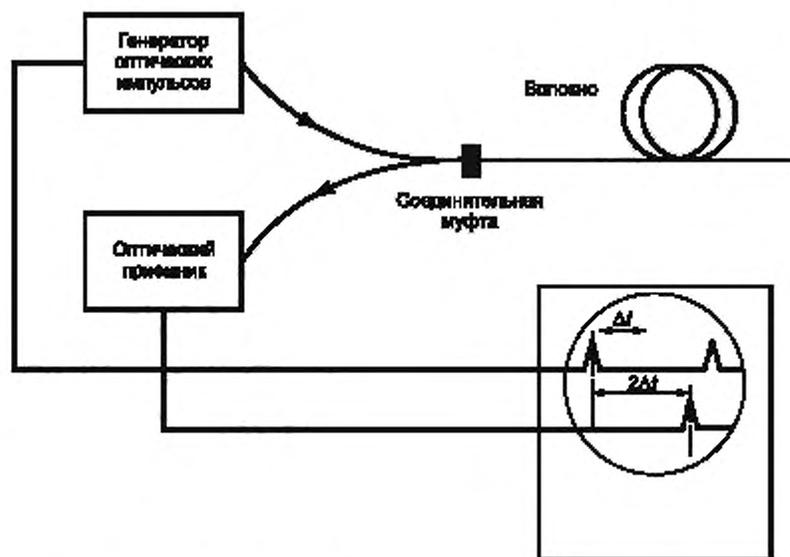
Рисунок А.2 — Измерение времени задержки отраженного импульса
