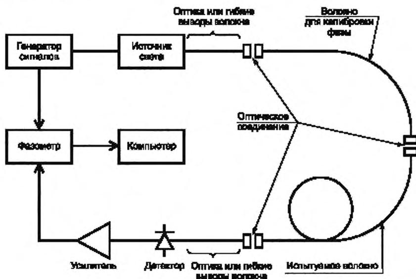
Рисунок Е.1 — Оборудование для измерения длины волокна
