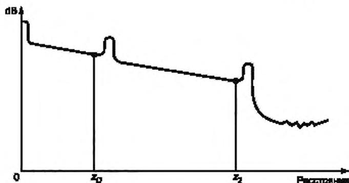
Рисунок В.5 — Схематичная линия OPVO образца (от  $z_D$  до  $z_2$ ) с секцией кабеля (например, компенсирующей катушкой с волокном) известной длины  $z_D$ , предшествующей ему (метод одной точки по В.4.3.3)
