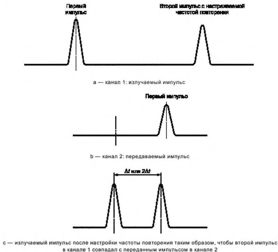
Рисунок А.3 — Принцип измерения длины волокна
