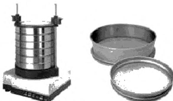
Рисунок 13 — Примеры оборудования для просеивания
