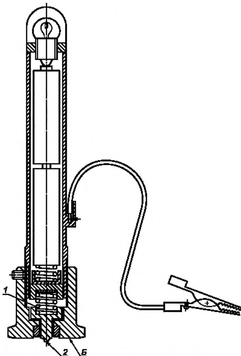
1 — пружина с усилием 10 Н; 2 — наконечник, которым проводят испытание царапаньем (стальная сфера диаметром 1 мм);
