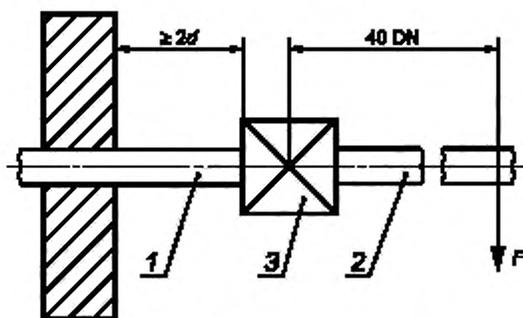
$d$  — внешний диаметр трубы; 1 — первая труба; 2 — вторая труба;
