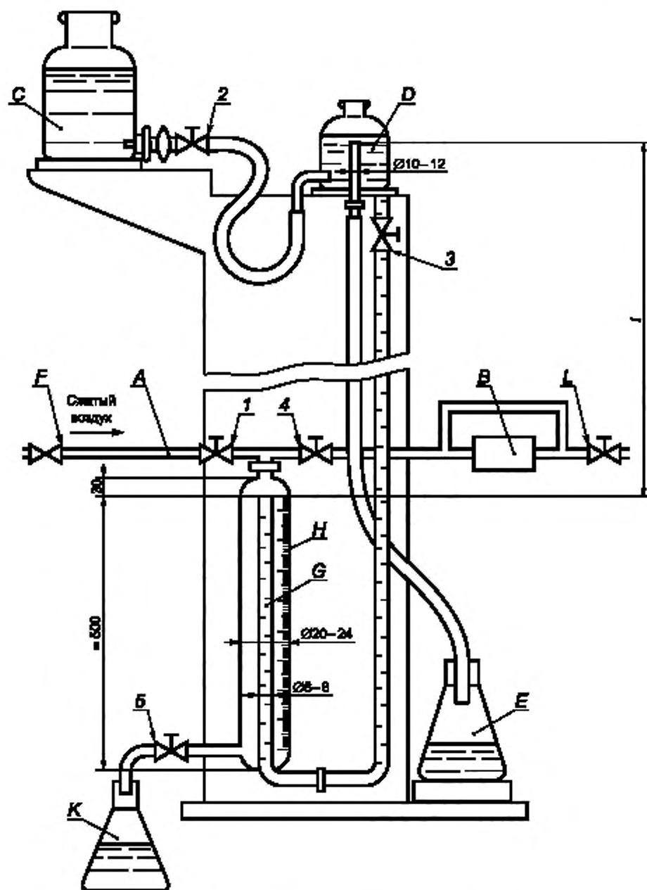
А — вход; В — испытуемый образец; С — емкость с водой; D — сосуд с постоянным уровнем воды; E, K — переливные сосуды;
