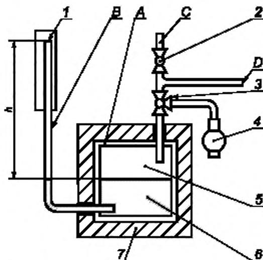
А — теплоизолированный сосуд давления; В — измерительная трубка; С — трубка под давлением; D — соединение с регулятором;
