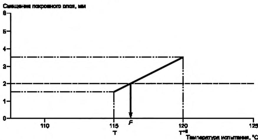
$T$  — температура, кратная 5 °С, при которой смещение покровного слоя менее 2 мм.
