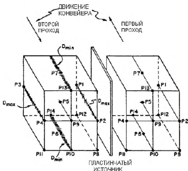
Примечание — Два прохода прямоугольной технологической загрузки, по одному с каждой стороны стационарного пластинчатого гамма-источника. Штриховкой показаны вероятные области максимальной и минимальной поглощенных доз после второго прохода. Буквами Р (с номерами) показаны положения дозиметров, которые могли бы использоваться для картирования поглощенной дозы в процессе оценки операционного качества.
