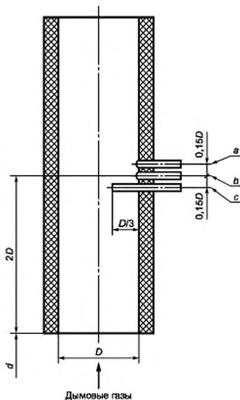
*a* — трубка для измерения температуры; *b* — трубка для измерения разрежения/давления; *c* — трубка для отбора проб продуктов сгорания на анализ; *d* — задняя стенка испытательной жаровой трубы
