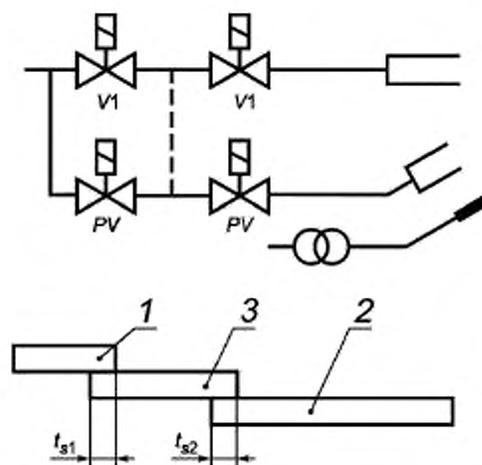
*V1* — основной предохранительный газовый отсечной клапан; *PV* — предохранительный отсечной клапан запальной горелки;  $t_{s1}$  — первое время безопасности;  $t_{s2}$  — второе время безопасности; 1 — зажигание; 2 — основная горелка; 3 — запальная горелка
