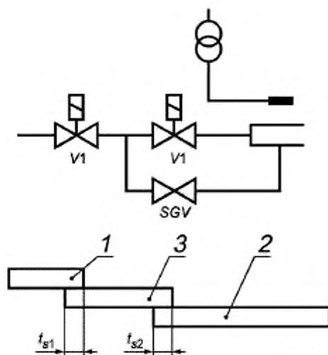
*V1* — основной предохранительный газовый отсечной клапан; *SGV* — предохранительный отсечной клапан подачи пускового газа;  $t_{s1}$  — первое время безопасности;  $t_{s2}$  — второе время безопасности; 1 — зажигание; 2 — основная горелка; 3 — пусковой газ
