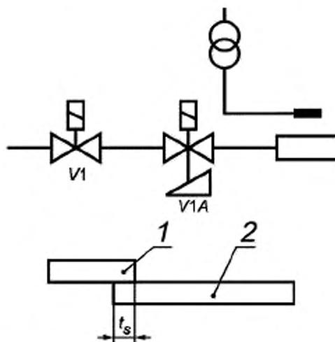
$V1$  — основной предохранительный отсечной газовый клапан;  $V1A$  — основной предохранительный отсечной газовый клапан медленного открывания;  $t_s$  — время безопасности; 1 — зажигание; 2 — основная горелка
