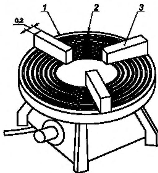
1 — плита; 2 — терморпара; 3 — деревянные бруски
