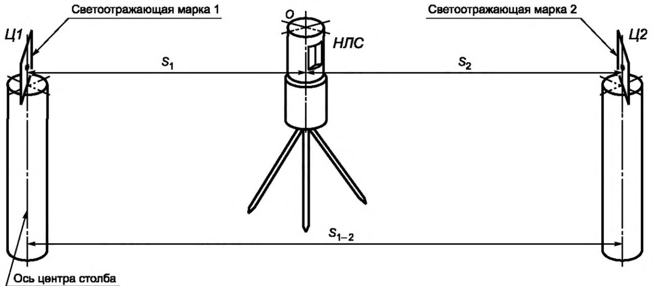
Рисунок 1 — Схема установки НЛС при определении погрешности измерений расстояний в полевых условиях
