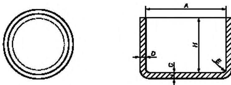
$A$  — внутренний диаметр, измеренный в верхней части;  $H$  — внутренняя высота;  $C$  — толщина дна;  $D$  — толщина стенок;  $E$  — внутренний радиус
