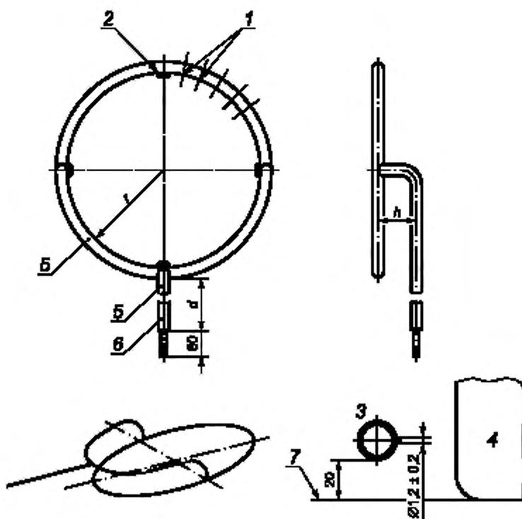
1 — расстояния между осями отверстий = 20 мм; 2 — четыре центрирующих блока, толщиной  $e$  (без отверстий в верхнем блоке); 3 — угол перекося к горизонтальным линиям ( $0_{-30}^0$ ); 4 — кастрюля; 5 — труба; 6 — труба 6x8; 7 — плоскость решетки
