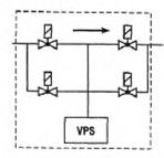
b – пример системы VPS с интегрированными клапанами
