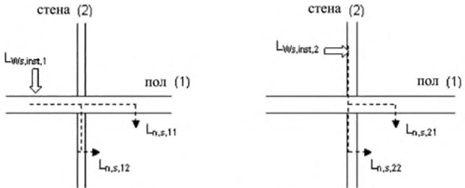
Рисунок 1.3 – Побочные пути косвенной звукопередачи
