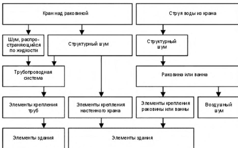
Рисунок 6 – Пути звукопередачи шума для настенного крана
