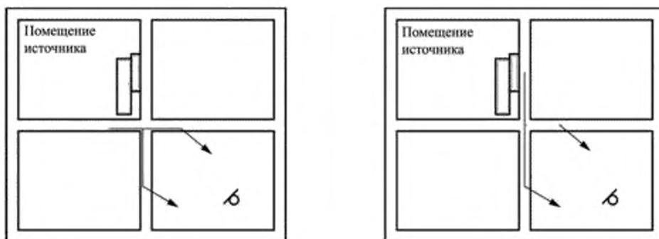
Примечание – В помещении источника стена и пол возбуждаются смывным бачком через монтажные опоры.
