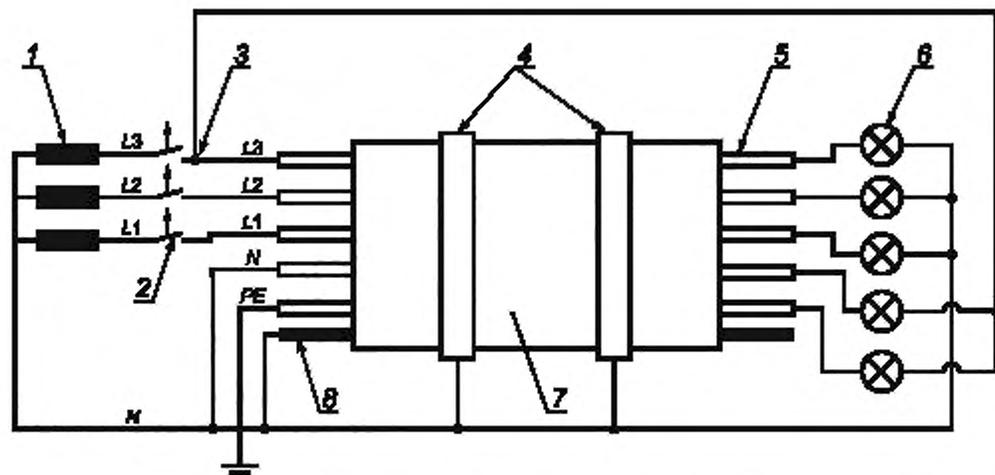
1 — трансформатор; 2 — плавкий предохранитель (2 А); 3 — подключение к фазе (или L1, или L2); 4 — поддерживающие кольца; 5 — испытываемая жила или группа жил, 6 — нагрузочный индикаторный прибор (например, лампа); 7 — образец, 8 — металлический экран (если имеется); L1, L2, L3 — фазные жилы (L2, L3, если имеются); N — нейтральная жила (если имеется); PE — защитная жила (если имеется)
