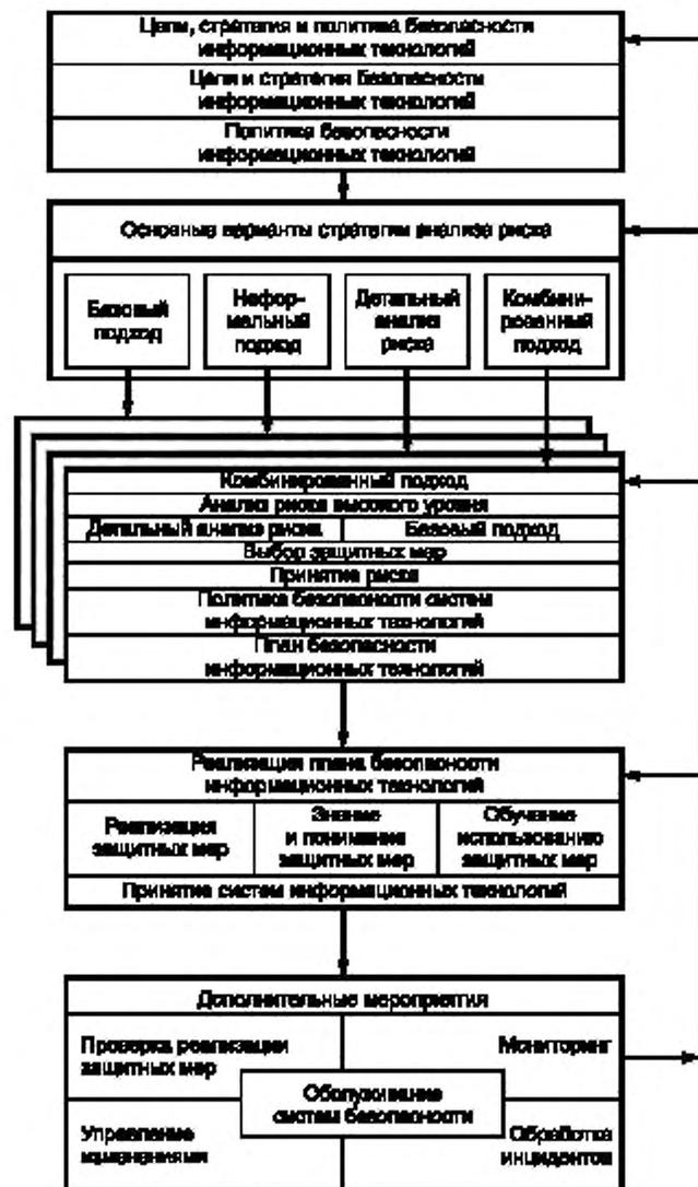
Рисунок 1 — Схема управления безопасностью информационных технологий
