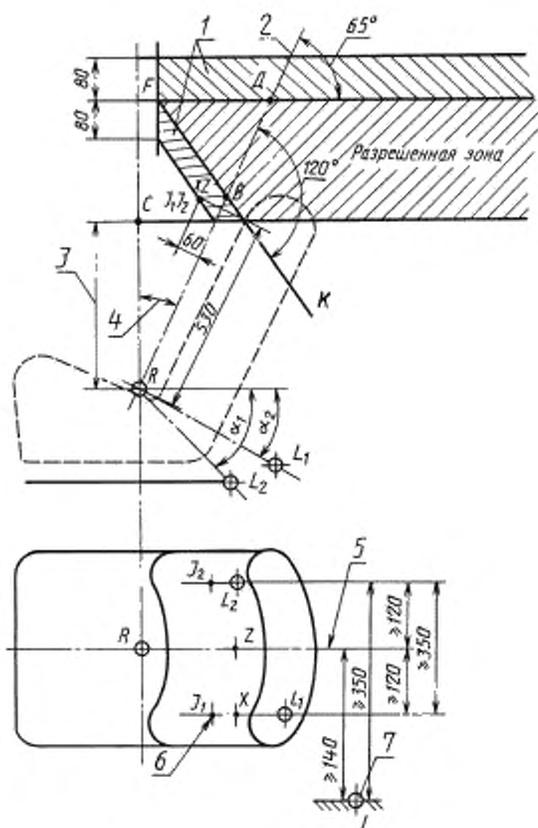
1 — зона, разрешенная для установки дополнительных мест крепления РБ; 2 — исходная линия спинки сиденья;
