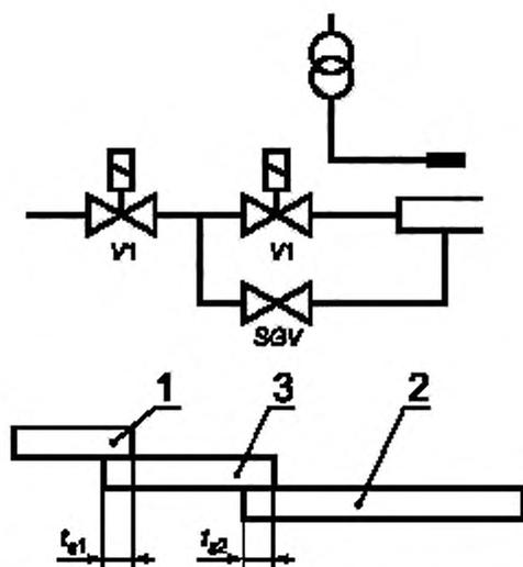
*VI* — основной предохранительный газовый отсечной клапан; *SGV* — предохранительный отсечной клапан подачи пускового газа;  $t_{b1}$  — первое время безопасности;  $t_{b2}$  — второе время безопасности; 1 — зажигание; 2 — основная горелка; 3 — пусковой газ
