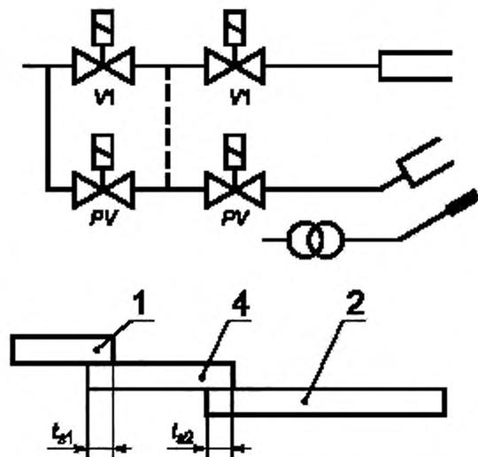
*VI* — основной предохранительный газовый отсечной клапан; *PV* — предохранительный отсечной клапан запальной горелки;  $t_{b1}$  — первое время безопасности;  $t_{b2}$  — второе время безопасности; 1 — зажигание; 2 — основная горелка; 4 — пилот
