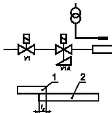
*VI* — основной предохранительный отсечной газовый клапан; *VIA* — основной предохранительный отсечной газовый клапан медленного открытия;  $t_b$  — время безопасности; 1 — зажигание; 2 — основная горелка
