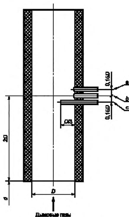
*a* – температура; *b* – разрежение/давление; *c* – анализ дымовых газов;
