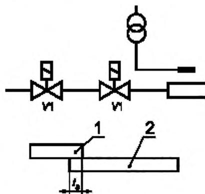
*VI* — основной предохранительный отсечной газовый клапан;  $t_b$  — время безопасности; 1 — зажигание; 2 — основная горелка
